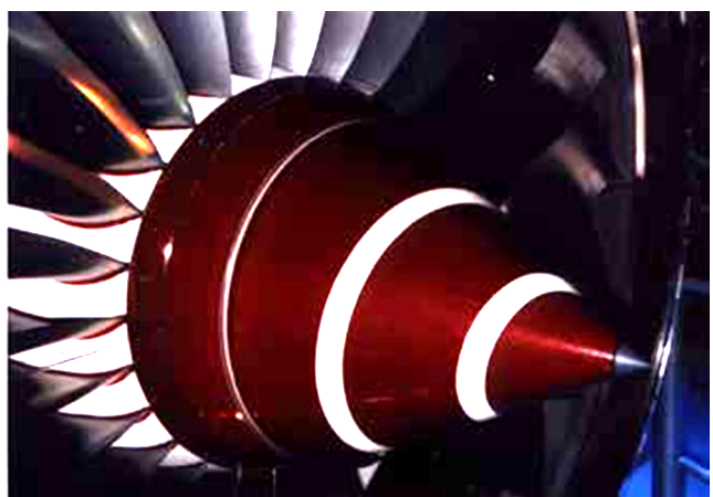
Stożek silnika pokryty dwuskładnikowym uszczelniaczem oraz elastomerową powłoką nawierzchniową EROS.
