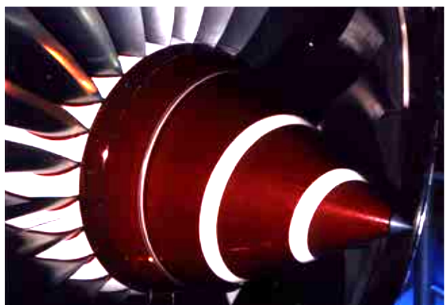
Cône d'entrée d'air de moteur revêtu d'un scellant à 2 composants et d'une couche de finition élastomère EROS.
