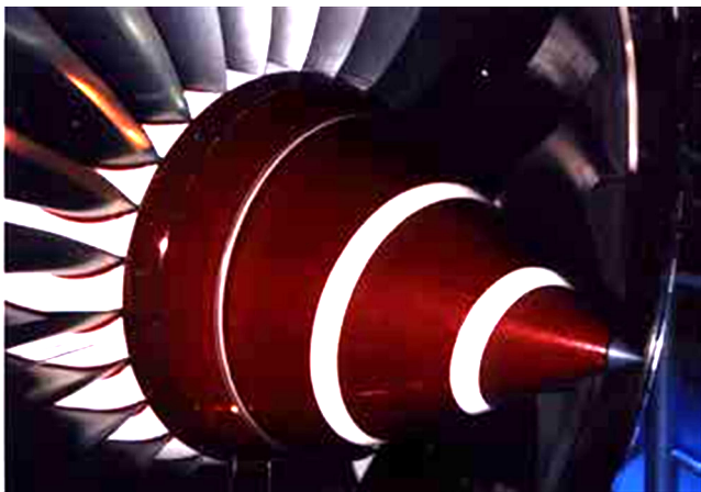
Cone de nariz do motor revestido com selador de 2 componentes seguido pelo acabamento elastomérico EROS
