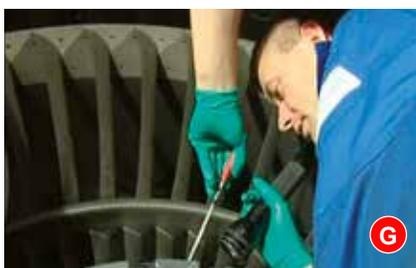
1. Die Schwalbenschwanznuten im Lüfterrad mit Reinigungsgriff und -rollen reinigen (A). Sämtlichen Trockenschmierstoffe (DFL) entfernen.
