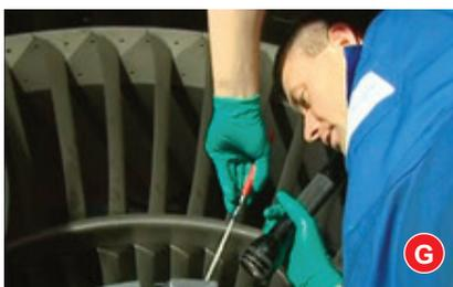
1. Pulire le fessure a coda di rondine del disco del ventilatore usando il dispositivo di pulitura con maniglia e i rulli (A). Rimuovere completamente tutta la pellicola lubrificante secca (DFL).
