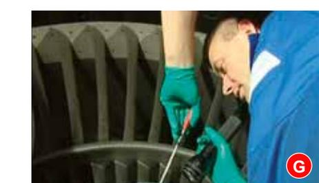
1. Nettoyez les encoches des queues d'aronde du disque de soufflante à l'aide du manche et des rouleaux de nettoyage (A). Enlevez toutes les traces de lubrifiant sec.
