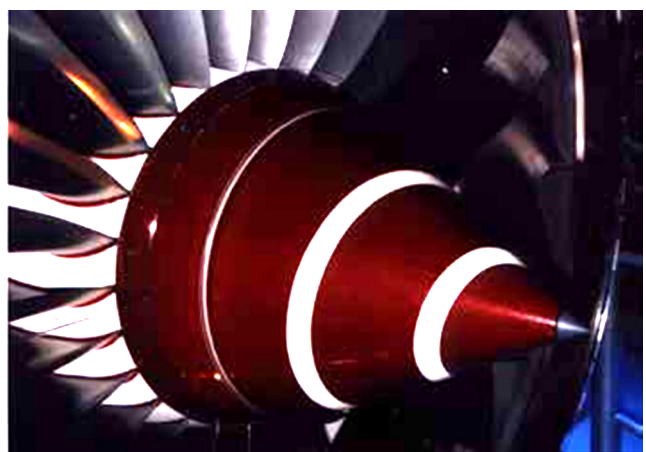
Motorneuskegel bedekt met 2-delig afdichtmiddel plus EROS-bovenlaag van elastomeer
