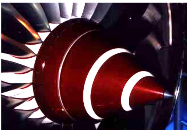
Mit 2-Komponenten-Dichtmittel plus EROS Elastomer-Deckschicht beschichteter Triebwerk-Nasenkonus.
